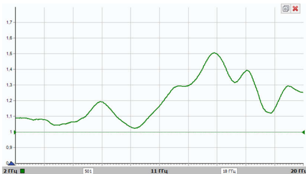
Рисунок И.6 – Результат измерения S_{22} в формате КСВН
