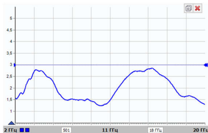
Рисунок И.4 – График КО, полученный в результате измерения параметров смесителя M2-0026 Marki Microwave
